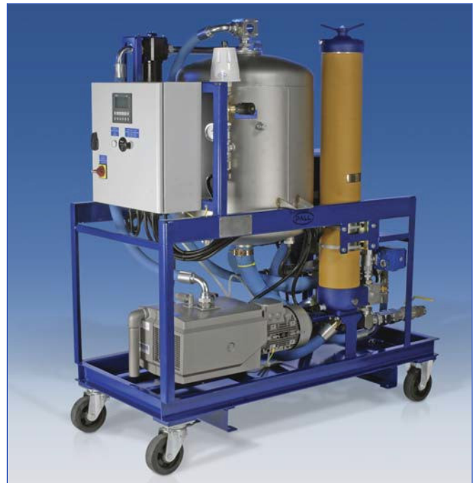
Установка для комплексной очистки масел модели HNP075
